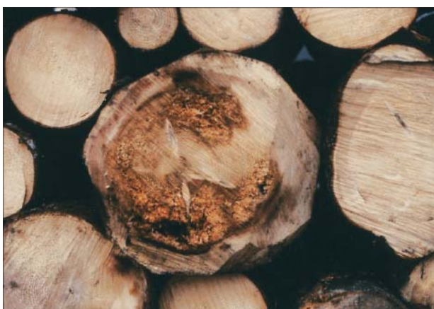
5 Fichtenrugel mit Faulstellen: ZN2, PN2 Rondin d'épicéa avec pourritures: CR2, PR2
