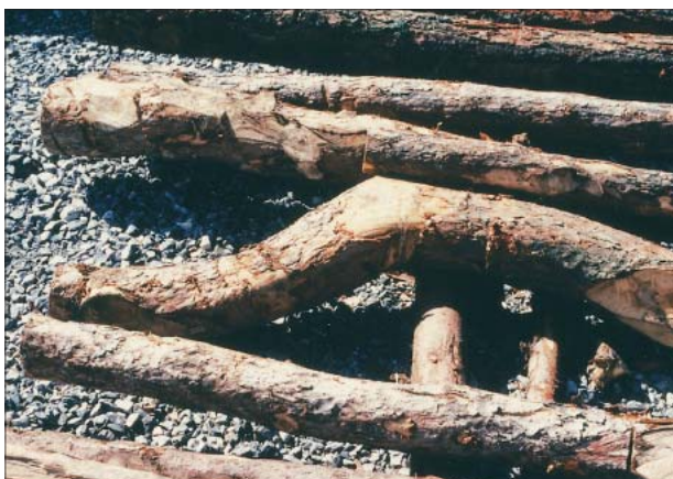
17 Plattenholz, Stamm mit Hakenkrümmung: Ausschuss Bois à panneaux, bille avec courbure en crochet: rebut
