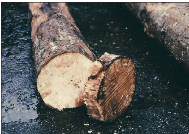
11 Qualitätskontrolle, rotstreifig: ZN2, PN2 Contrôle de qualité, veines rouges: CR2, PR2
