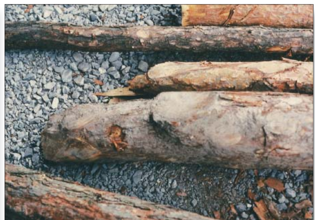
18 Plattenholz, stark verschmutzter Stamm: Ausschuss Bois à panneaux, bille très sale: rebut
