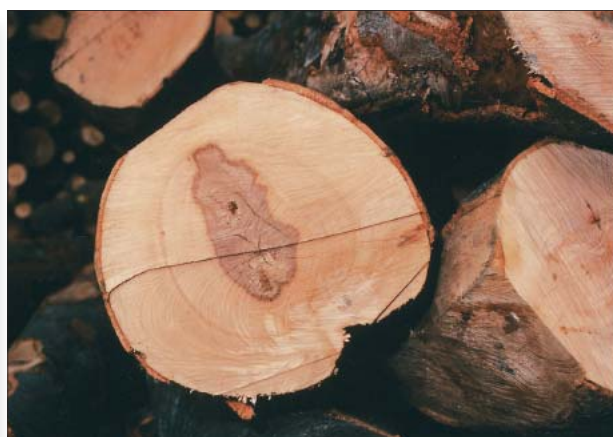
4 Buche mit natürlichem Farbkern, gesund: ZL1 Hêtre à cœur coloré naturel, sain: CF1
