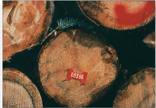
20 Plastiknummern = Fremdkörper: vor der Lieferung entfernen Numéros en plastique = corps étranger: à enlever
