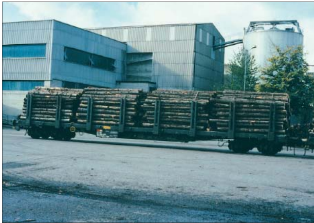
21 Länge auf Transport abgestimmt (Sps-Wagen, Lastgrenze 53 t) Longueur adaptée au transport (wagon Sps, limite de charge 53 t)
