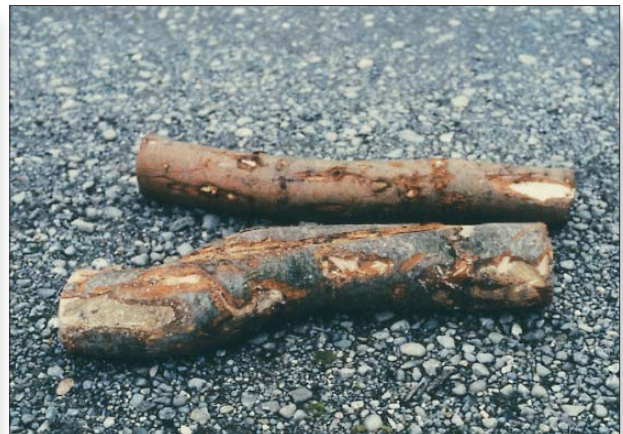
10 Krümmung; bis 10 cm: ZN, PN2; über 10 cm: Ausschuss Courbure; jusqu'à 10 cm: CR, PR2; plus de 10 cm: rebut
